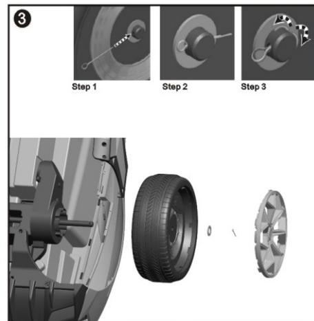
3. Соберите все детали в последовательности, как показано на рисунке. Вставьте штифт в отверстие передней оси и с помощью плоскогубцев сделайте его в форме "М". «Защелкните» колпак в центр. Повторите процесс для другой стороны.
