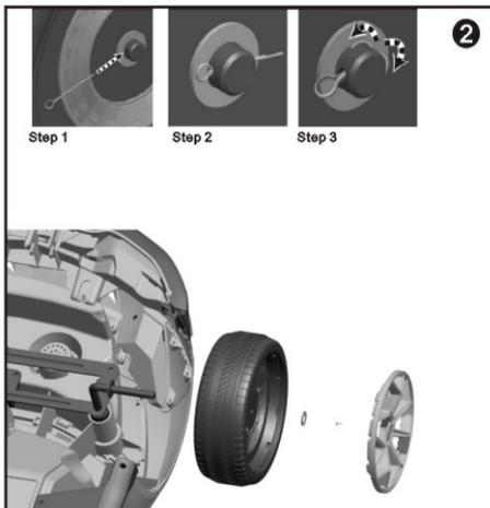
2. Соберите все детали в последовательности, как показано на рисунке. Вставьте штифт в отверстие передней оси и с помощью плоскогубцев сделайте его в форме "М". «Защелкните» колпак в центр. Повторите процесс для другой стороны.
