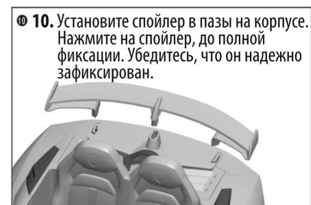
10. Установите спойлер в пазы на корпусе. Нажмите на спойлер, до полной фиксации. Убедитесь, что он надежно зафиксирован.
