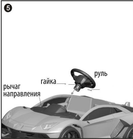
5. Штекерные разъемы. Поместите рулевое колесо на рулевую тягу и закрепите его болтом и гайкой.
