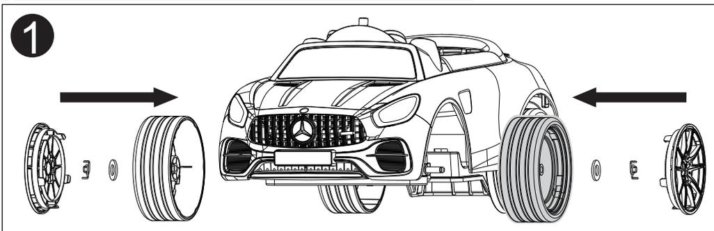
Установите колесо, шайбу, стопор на переднюю ось, как показано на рисунке, затем окончательно закрепите крышку колеса.
