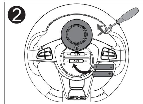
Откройте крышку батарейного отсека, замените батареи (в правильной полярности), затем затяните винт, чтобы закрыть крышку
