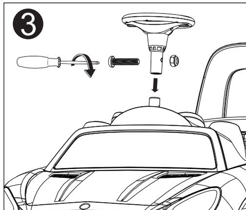
Вставьте рулевое колесо и закрепите болтом с гайкой, как показано на рисунке.
