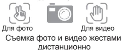
1. Снять фото: Расположите руку на расстоянии примерно 1,5 м от переднего объектива и удерживайте жест в течение 3 секунд.
