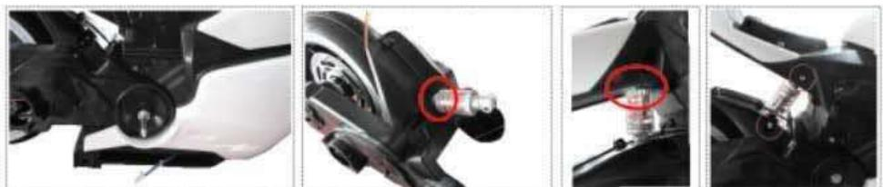
Снимите вал с кузова
