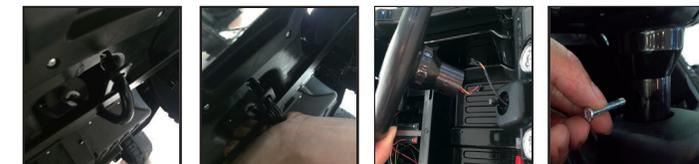
По причине смещения рулевой колонки иногда существует вероятность того, что отверстие на рулевом колесе и отверстие на рулевой трубе могут не совпадать. Если это произошло, пожалуйста, одной рукой придержите крюк под кузовом автомобиля, чтобы зафиксировать рулевую трубу. (См.на фото).
