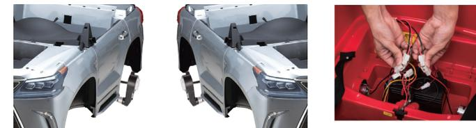
Найдите коробки передач в автомобиле и отсоедините коннекторы. Подключите редукторы к оси, а затем вставьте провода редукторов в отверстие в кузове автомобиля. (Для справки см фотографии) и повторно подключите коннекторы к проводам электропередачи.
