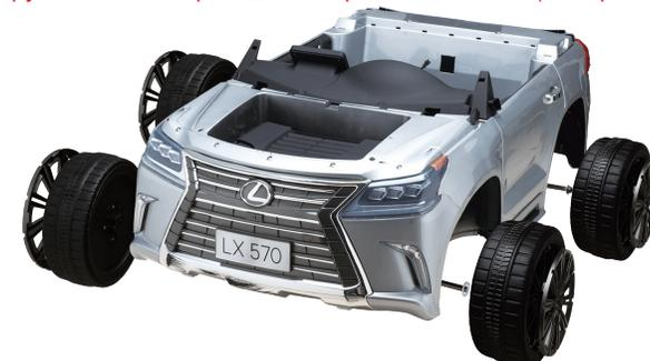
Извлеките втулки из пакетов с винтами и болтами и вставьте их на внутреннюю и внешнюю стороны передних колес, а также на внешние стороны задних колес, затем посадите одну металлическую шайбу на ось, а затем посадите колесо на ось. Далее вставьте шплинты в отверстие на оси, а затем согните усики шплинта поперек (см. фото). Наконец, установите крышку на колеса
